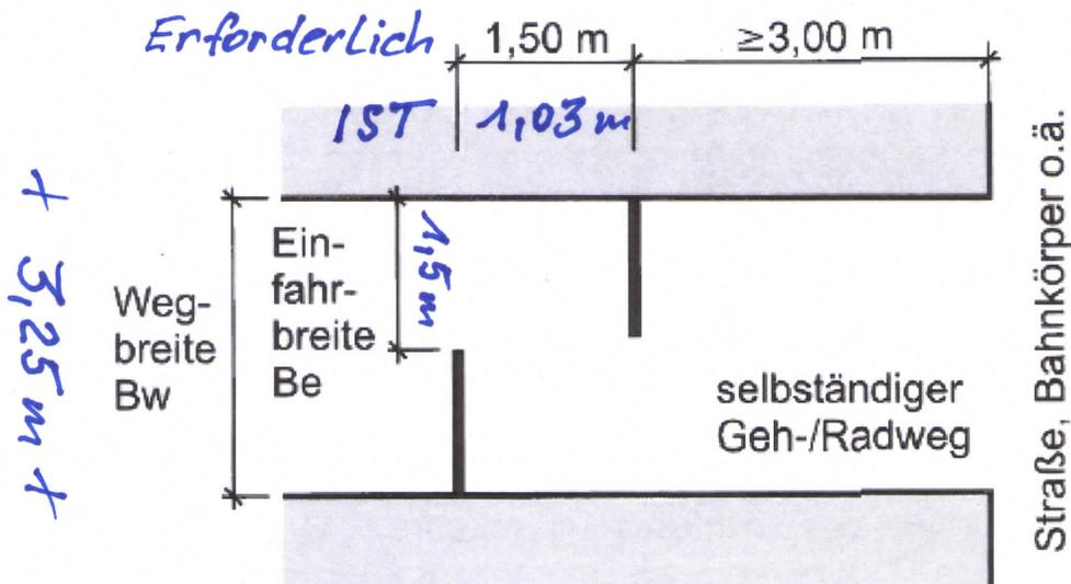
Bild 90: Umlaufsperrung an einem selbständigen Geh-/Radweg
