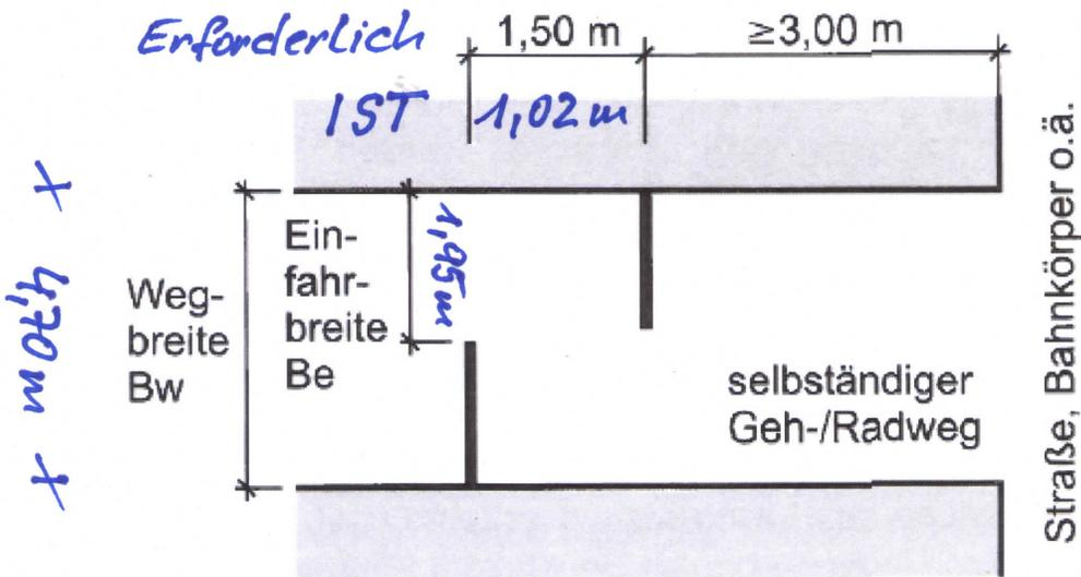
Bild 90: Umlaufsperrung an einem selbständigen Geh-/Radweg
